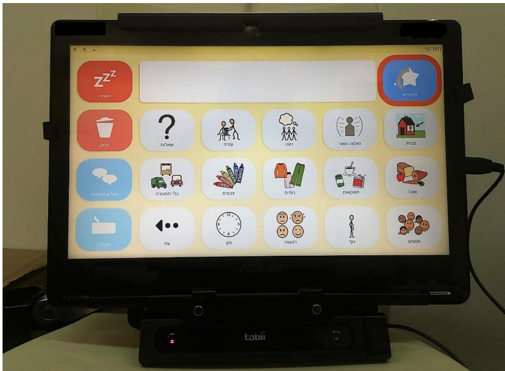
מחשב לתת"ח עם מצלמת מיקוד מבט הקולטת את תנועת האישונים (מתחת למחשב).
